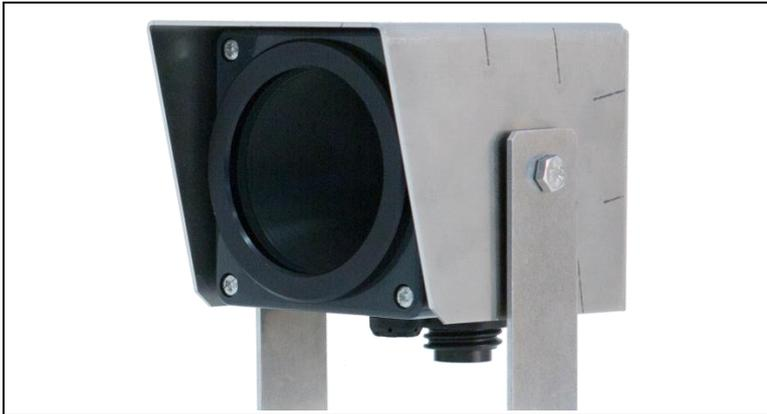
Die Verkehrsdetektoren der Serie TDC2 vereinen Passiv-Infrarot (PIR) und Ultraschall (US) als Erfassungstechnologien zur zuverlässigen Erkennung von fahrenden und stehenden Fahrzeugen. Zusätzlich zur RS 485 Datenschnittstelle bedient der Detektor ein SPST Relais.
