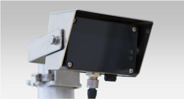
Der Verkehrsdetektoren der Serie TDD1-MW verwenden Doppler-Radar Technologie zur Erfassung von Verkehrsteilnehmern. Die Detektoren sind ausgelegt für die Erfassung von Objekten, welche sich in oder durch den Erfassungsbereich bewegen. Der Relais-Ausgang ist aktiviert, solange ein sich ein bewegendes Objekt im Erfassungsbereich befindet. Die werksseitig eingestellte Konfiguration kann mittels der IR-Fernbedienung geändert werden
