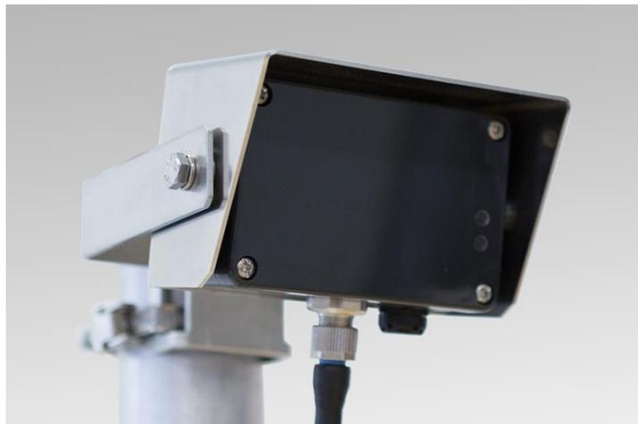
La serie TDD1 - MW de detectores de tráfico utiliza la tecnología de radar Doppler de microondas para la detección de vehículos en movimiento a través de su campo de visión. Durante la duración de la detección, se activa una salida de relé de cierre de contacto. Cuando termina la detección, el contacto se libera en su estado normal. La configuración de fábrica se puede cambiar fácilmente utilizando un control remoto IR (accesorio adicional).
